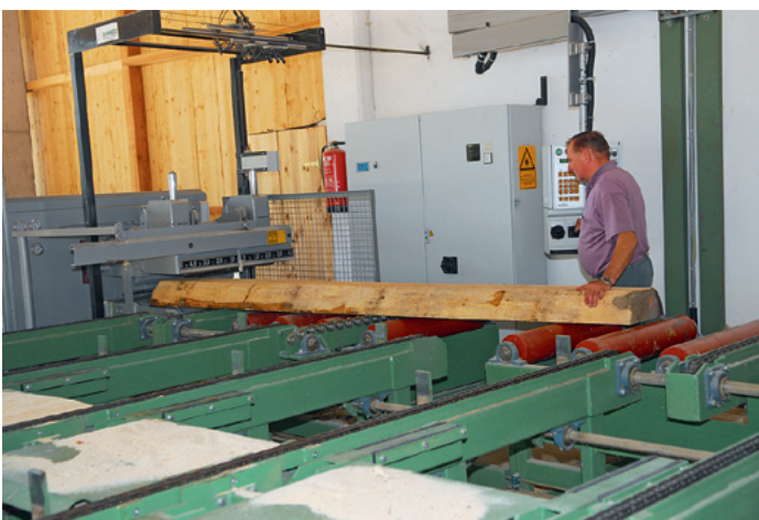
Bediener Franz Buchinger richtet die Model exakt nach den Laserlinien für den Einschnitt aus
