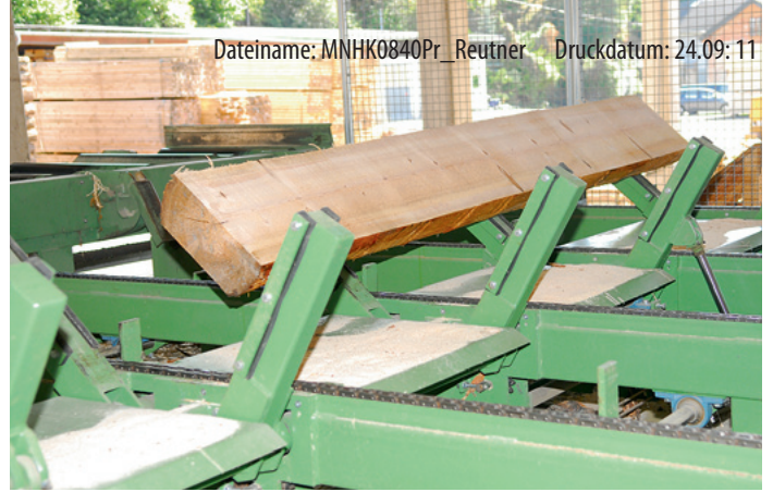
Mit der Wendevorrichtung können die Model um 180° gedreht werden, damit die linke Seite oben liegt
