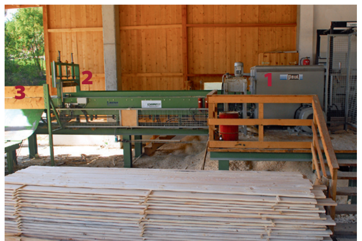
Nachschnitt-Kreissäge (1), Auszugsrollenbahn mit gesteuerter Druckrolle (2), Querabräumtisch (3)
