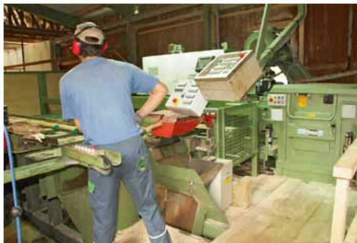
Die ankommende Ware vom Gatter wird bei Bedarf gekappt und der neuen Paul-AB 920 zugeführt
