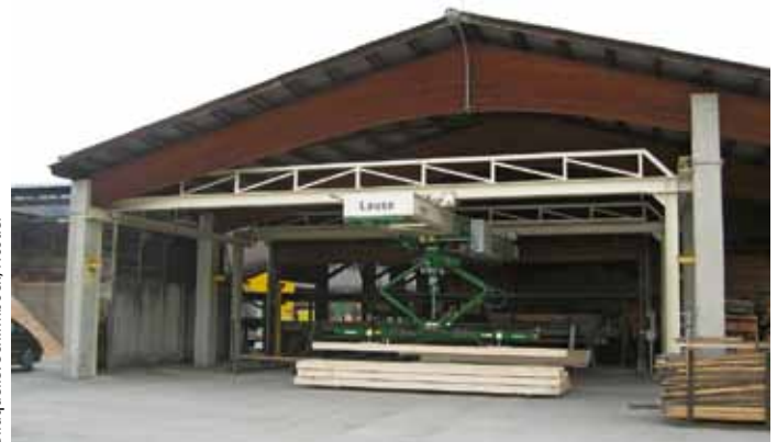
Mit der neuen Vakuumtransportanlage von Lause wird bei Liechtenstein Holztreff die Hauptware sicher gestapelt
