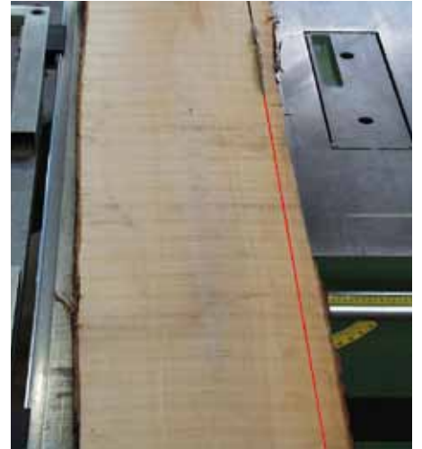
An der Formatsäge sorgt der Linienlaser für einen exakten Zuschnitt
