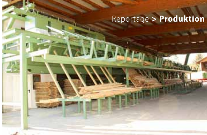
Über die gesamte Hallenlänge erstreckt sich die neue Sortierung an zwölf Stationen
