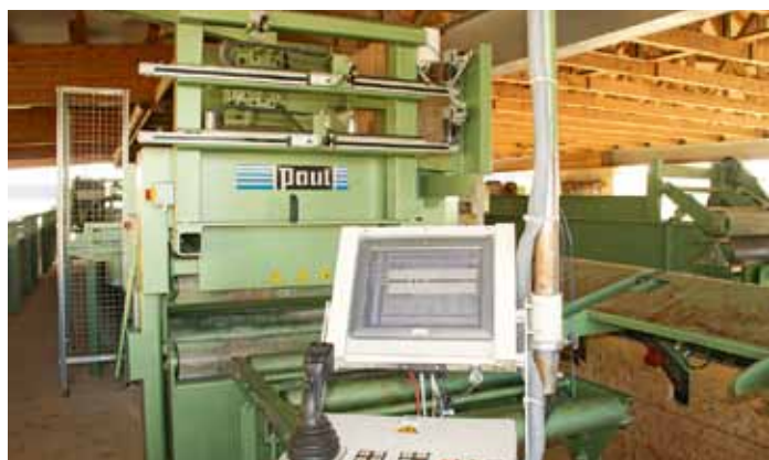
Am Bedienpaneel Maxirip XL lassen sich alle relevanten Daten einfach einstellen und abrufen
