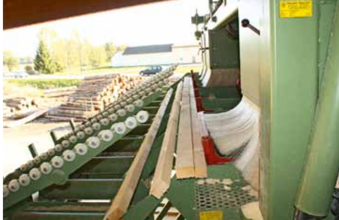
Querkappung von Mayrhofer für maßgenaues Schnittholz mit anschließender Sortierung
