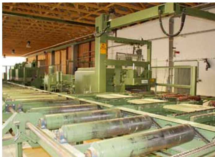
Rollengang hinter der Bandsäge , nach rechts geht's zur Nachschnitt-Kreissäge 5900 von Paul
