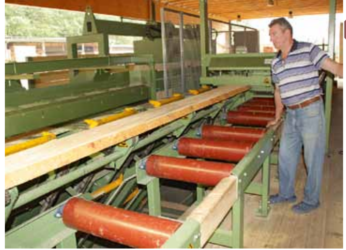
Seitenware gelangt über Lause-Vereinzelungsförderer zur Paul-Besäumkreissäge
