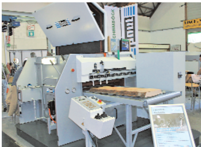
Auftrennsäge K 34V/1000 von Paul: vielseitige Einsatzmöglichkeiten im Hart- und Weichholz-Bereich
