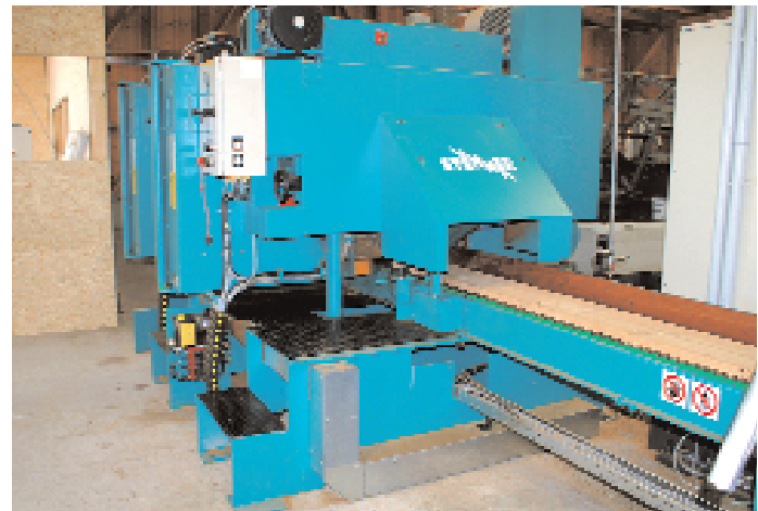
Reduzierte Schnittfuge bei der Herstellung von Decklamellen durch Mehrkopfbandsäge
