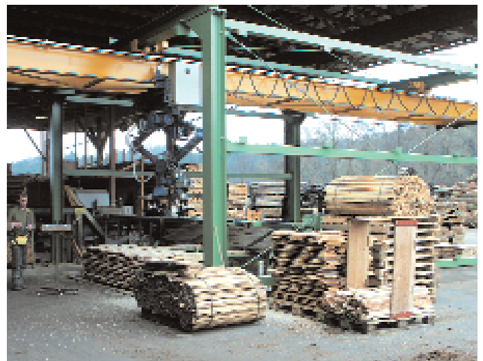
Mit neuer Vakuum-Transportanlage von Lause kann Schnittholz ohne Kraftaufwand sauber abgestapelt werden
