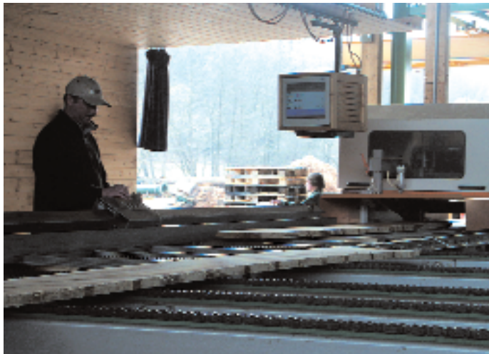
Einteilung der Schnittware erfolgt über einen Messwagen – Laser zeigt Bediener die aktuelle Position an
