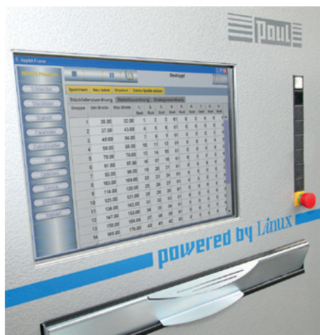
Bedienterminal der CNC-Steuerung Maxi 6 mit Touchscreen
